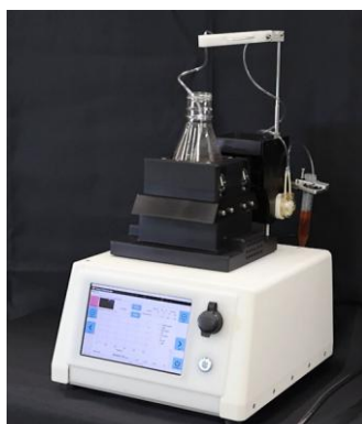
培養条件の制御、測定、試薬添加を自動化する「ACKNOS Microbial Shaker」
