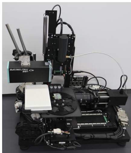
有望な細胞や分子の検出、回収、移載を自動化する「FARIOS」
